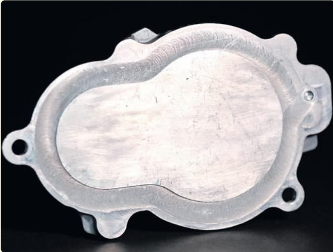
FSW eines gewalzten Blechs in ein Aluminiumdruckgussgehäuse
